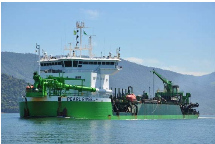
TSHD 'Pearl River' exécute des travaux de dragage d'approfondissement à Porto Sudeste, dans la Baie de Sepetiba, Rio de Janeiro, au Brésil
